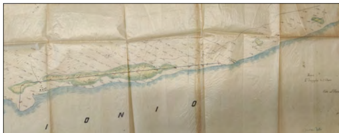
FIGURA 19. Una delle cartografie (del 1915) allegate ai progetti di bonifica (dall'Archivio di Stato di Lecce) dalla quale si evince l'estensione delle aree palustri e il progetto del canale che le doveva drenare.
