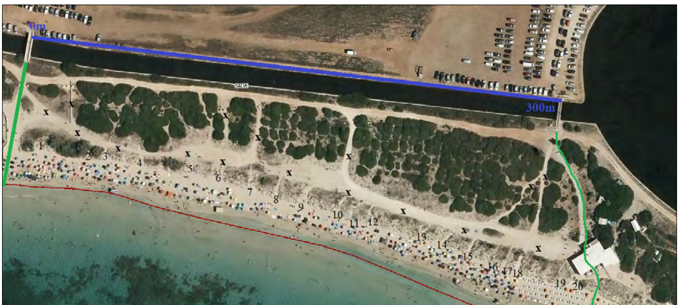
FIGURA 23. Esempio di un tratto in cui in appena 300 m sono presenti circa 20 tagli trasversali al cordone dunale per l'accesso, una viabilità parallela al cordone (indicata con x) che di fatto lo attraversa e numerosi altri tagli nelle aree retrodunali (sempre con x). In verde gli attraversamenti che potrebbero essere consentiti realizzandoli nel rispetto delle originarie morfologie. Tutti gli altri percorsi dovranno essere rinaturalizzati.
