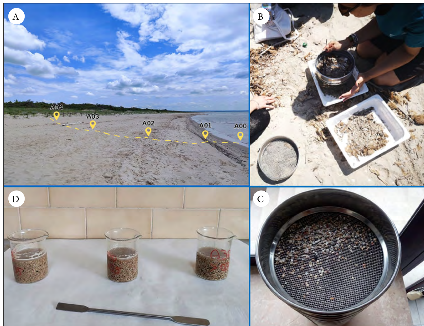
FIGURA 3. Campionamento e analisi dei sedimenti di spiaggia per l'identificazione delle MPs. (A) Definizione punti di campionamento sulla spiaggia emersa; (B) campionamento in situ dei sedimenti tramite setaccio da 5 mm; (C) setacciatura dei sedimenti in laboratorio; (D) ossidazione della sostanza organica per la preparazione dei campioni alla fase di separazione delle MPs.
